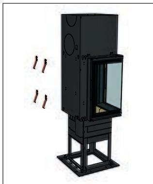
Die 6 Federstahllaschen wieder an der neuen Position anschrauben.
