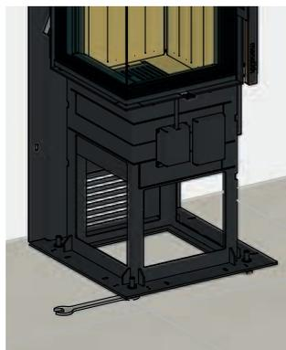
Nachdem alle Anschlüsse und Prallplatte montiert sind, den Heizeinsatz mit einer Wasserwaage durch Einstellen der Stellfüße ins Wasser bringen. Hier ist darauf zu achten, dass an der Front sowie an den Seiten die Ausrichtung kontrolliert wird (s. Bilder).
