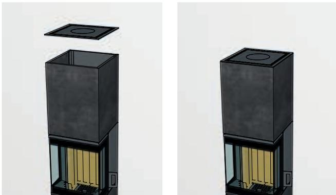
Bei einem Rauchrohrabgang hinten kann die Topplatte oben auf den Heizeinsatz gelegt werden. Hierbei ist darauf zu achten, dass die zwei angebrachten Bolzen der Topplatte in die vorgesehenen Löcher geführt werden.
