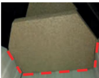
Für die Montage der unteren Umlenkplatte wird ein Seitenstein entfernt und die Umlenkplatte auf die obere Auflagefläche der Schamotte platziert. Nach Montage der Umlenkplatte den Seitenstein wieder einbauen.
