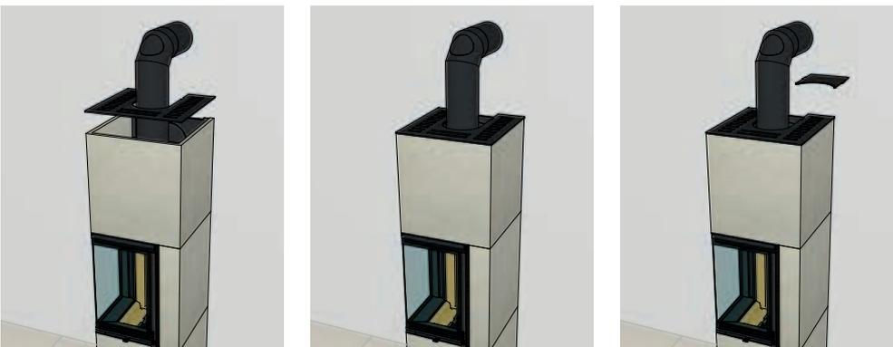
Bei einem Rauchrohrabgang oben kann die Topplatte vorsichtig oben auf den Heizeinsatz gelegt werden (ohne dass das Rauchrohr verkratzt wird). Hierbei ist darauf zu achten, dass die zwei angebrachten Bolzen der Topplatte in die vorgesehenen Löcher geführt werden. Anschließend wird der hintere Einleger montiert.
