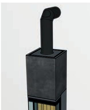
Bei einem Rauchrohrabgang oben müssen zunächst die Abstandshalter entfernt und danach kann die Topplatte vorsichtig oben auf den Heizeinsatz gelegt werden (ohne dass das Rauchrohr verkratzt wird). Hierbei ist darauf zu achten, dass die zwei angebrachten Bolzen der Topplatte in die vorgesehenen Löcher geführt werden.
