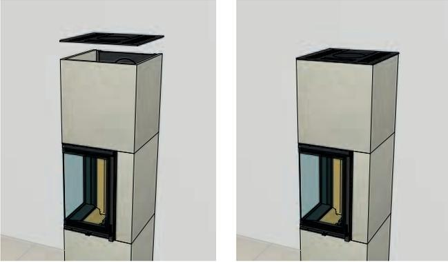
Bei einem Rauchrohrabgang hinten kann die Topplatte oben auf den Heizeinsatz gelegt werden. Hierbei ist darauf zu achten, dass die zwei angebrachten Bolzen der Topplatte in die vorgesehenen Löcher geführt werden. Anschließend den hinteren Einleger und den runden Einleger montieren.
